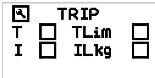
Рисунок Е.4 – Флаги защитного отключения
